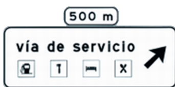
S-264 Preseñalización en carretera convencional de una vía de servicio
