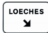
S-350 Señal sobre la calzada, en carretera convencional. Salida inmediata hacia carretera convencional
