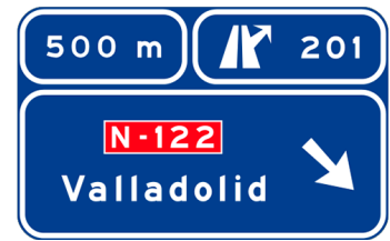
S-235 Preseñalización con señales sobre la calzada en autopista o autovía hacia cualquier carretera
