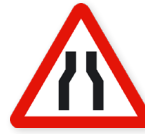
P-17 Estrechamiento de calzada
