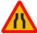
TP-17 Estrechamiento de Calzada por Obras
