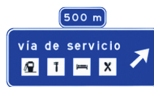
S-266a Preseñalización en autopista o autovía de una vía de servicios con salida exclusiva
