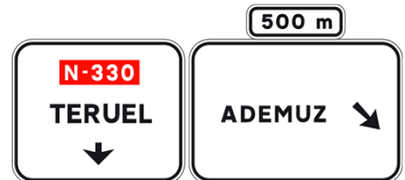
S-230a Preseñalización con señales sobre la calzada en carretera convencional hacia carretera convencional y dirección propia
