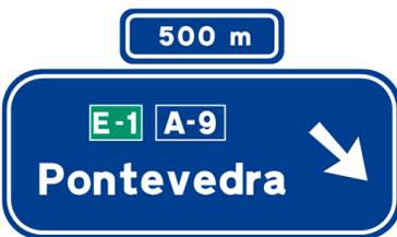
S-232 Preseñalización con señales sobre la calzada en carretera convencional hacia autopista o autovía
