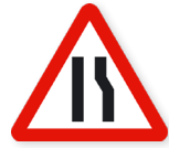
P-17a Estrechamiento de calzada por la derecha
